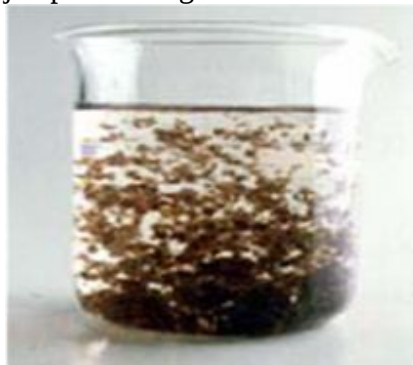
Figura 3. Ejemplo de coagulación – floculación del agua
