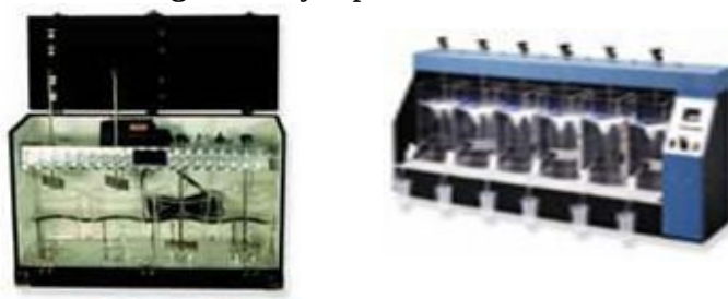
Figura 4. Ejemplo de Test Jar
