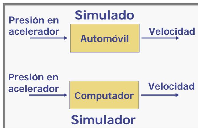
**Figura 4. El mismo ejemplo de la Figura 3, pero utilizando una computadora como simulador. Esto es posible gracias a que la computadora es un sistema de propósito general que puede simular múltiples sistemas.**
