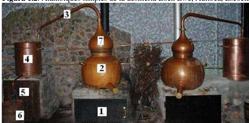
Figura 1.2. Alambiques simples de la destilería Loch Ewe, Aultbea, Escocia.
