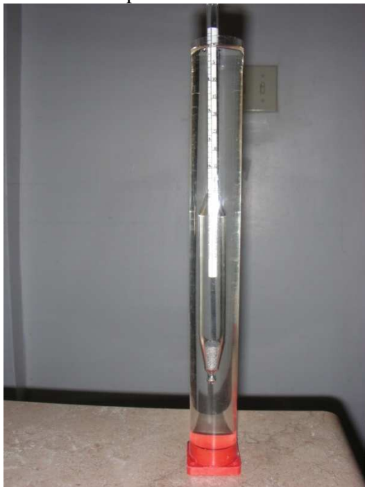
Figura 1.5. Alcoholímetro inmerso en la probeta conteniendo la mezcla etanol-agua bajo análisis.
