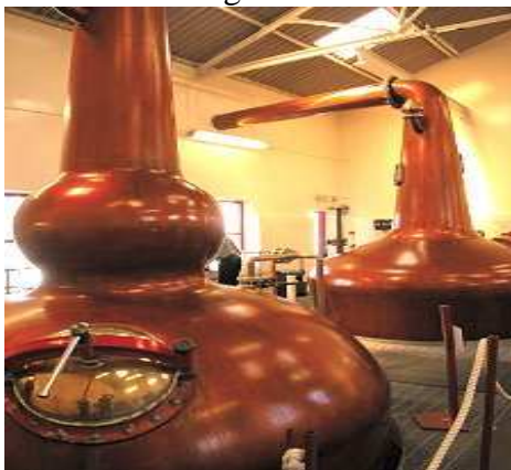
Figura 1.3. Alambiques de cuello de ganso de la destilería Benromach, Escocia.
