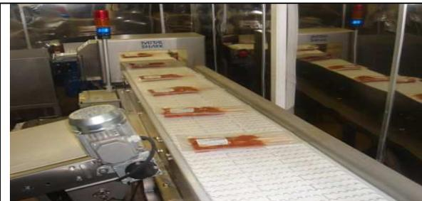
Los sistemas de transporte también deben cumplir con las normas GMP, y deben mantenerse en condiciones de higiene y sanitización adecuados, debiendo estar construidos bajo las mismas normas de los equipos, maquinas y utensilios.
